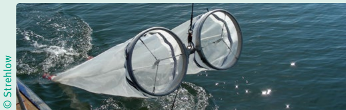
Bongonetz – das typische Fanggerät für Heringslarven zur Bestimmung der Stärke der Nachwuchsjahrgänge
